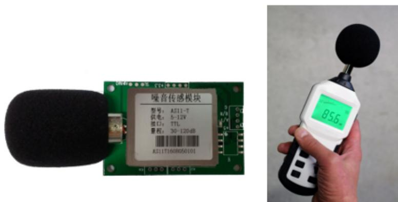
Fig. 34. Ejemplo de dispositivos que permiten la medición del ruido
