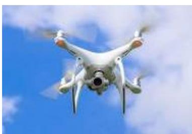
Fig. 16. Dron de 4 hélices con cámara móvil incorporada
