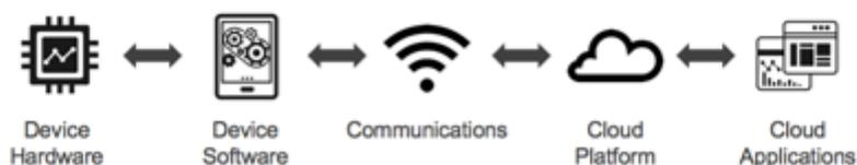
Fig. 40. Elementos que componen un proyecto de Internet de las Cosas
